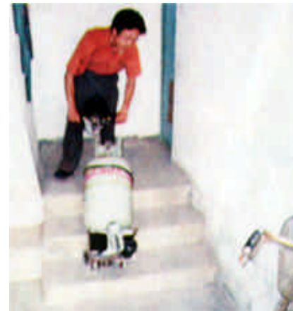
上图：别看机器人的个头小，劲可不小，背着60斤重的气罐爬到5楼，只需要五分钟。
